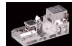
配合扫描电镜使用的压痕检测仪
