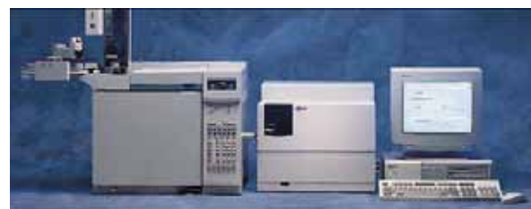
气相色谱/原子发射光谱联用仪(Jas GC-AED)
