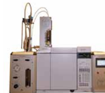
DVE和Shell紧密合作,开发了液化气直接进样器(LGI)
